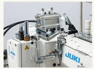
ペダルの踏み返しにより、押えの上げ下ろしができます。 頻繁な作業だからこそ、オペレーターの疲労を軽減します。
