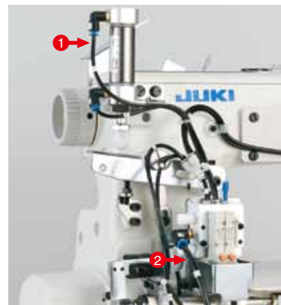
① 抬升压脚驱动装置 ② 切线驱动装置
