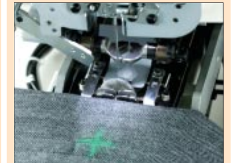
绕脚在第2个工序中完成(安装绕脚缝制组件)
