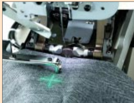
钉扣和绕脚1个循环就能完成
