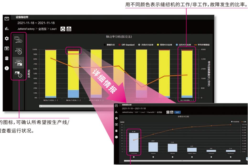
可确认各故障项目发生的时间。通过改善减少这些故障,可以提高生产性。
