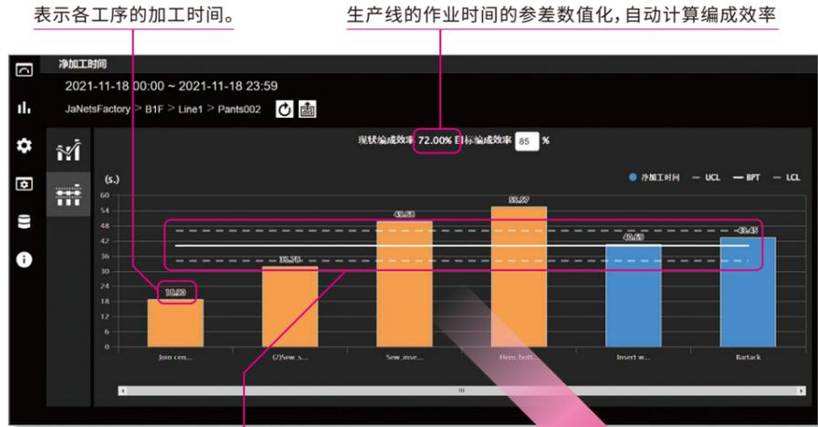
表示实际生产线的平均加工时间。此外, 还显示两条虚线, 以确保生产顺利进行。在上限/下限内的工作时间为蓝色, 超出上限/下限的工作时间以橙色显示, 蓝色较多时波动变化较小, 生产稳定, 橙色较多时平衡不良, 容易发生等待工作和半成品的积压。
