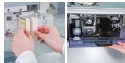
带关闭传感器的外壳 防止开口时的启动, 缝制过程中的自动停止, 更安全的工作。
