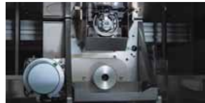
垂直全回转3倍旋梭 采用3倍旋梭, 即使使用粗线, 也不需要经常更换梭芯, 对应大型缝制。
