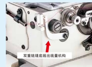
双重链缝底线出线量机构
