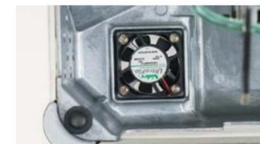
通过冷却扇的配置能够减少旋梭部位的发热。
