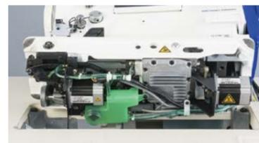
通过机头润滑脂的供给实现干机头。减少了缝制品沾上油污的情况发生。
