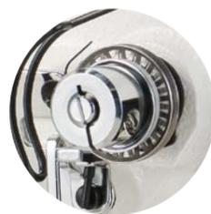
采用了世界上初次使用的旋转式电子夹线器。迄今为止困难的，下线残余量减少时夹线器的稳定化进行修正。
