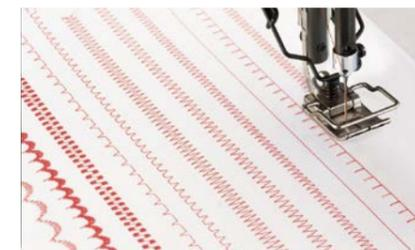
基本的缝制形状有12种·标配20个花样。从缝纫机本体的新型操作面板可以选择曲折缝，T型压明线，模板缝等缝制花样，设备的工作效率大幅提升。另外，对于胸罩的骨架部分缝制不包含在内，跳针工序的缝制均可对应，可以作成缝制的图案的原因，可以更加提升生产效率。
