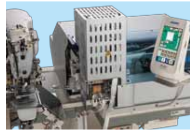
切鞋襻，采用电热切断（热切刀）可以防止错位，实现稳定尺寸的剪断。
