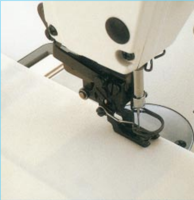
薄料缝 (防止错位、缩缝、HA 型量规)
