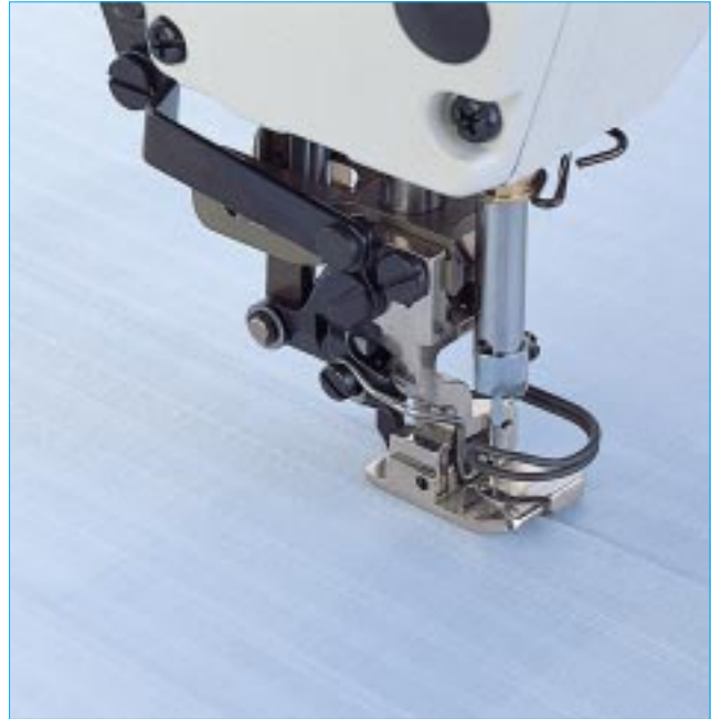
止口缝 (DD 型量规)
