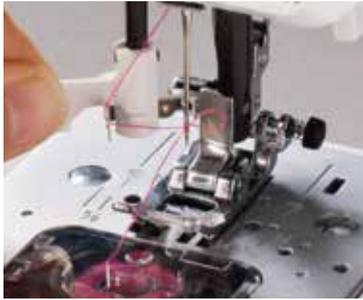
面倒な針穴への糸通しは、レバーを下げてクルッと押し戻すだけ。簡単でラクに糸が通ります。
