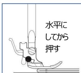
押えの手前を押し下げて押えを水平にしてから黒いボタンを押します。
