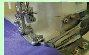
ニットテープを2本糸チェーンステッチで縫い付けることができます。テープは自動的に折り込まれ、衿ぐりなど生地端を挟み込みながら縫ったり、キャミソールの肩ひもなどの紐(ひも)を作ることができます。
