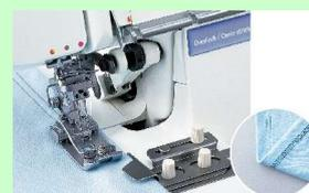
カバーステッチで見難い裏側の生地端の位置や折り幅をガイドできます。生地はあらかじめ縫いたい幅に折っておき、折り幅に合わせてガイドの位置を調節します。洋服の裾や袖口などの処理に最適です。
