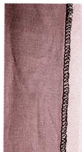
● 縫い目に布端が飛び出しているか、カールしている。
