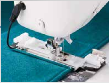
独自のセンサーで送りを補正
