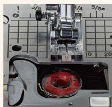
下糸巻きの準備は、ボビンに糸を巻きつけてガイドに通すだけ。いつでも下糸を巻くことができ、巻き終わった糸をその場でカットできます。
