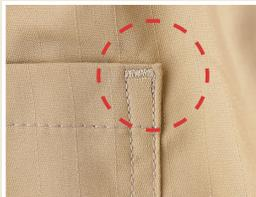
パッチポケットの角の補強に。ステッチ幅と同じ7mmで設定した。
