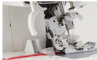
糸切りバサミを使わずに、空環をカットできます。しかも、手もとの手動ボタンか足もとのフットスイッチ、または空環の長さを設定すれば、縫うだけでセンサーが反応して自動でカットすることも可能に。面倒な糸切りから解放されてどんどん作業が進みます。
