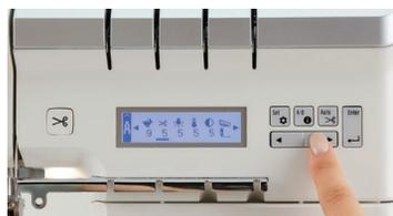
最大縫いスピードや自動空環カットの長さ、LEDライトの色温度やフットスイッチ操作時の動作の設定変更が可能です。
