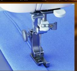
段部の左側3.0mmの位置を安定して縫えます。 薄地から厚地まで幅広く使えます。
