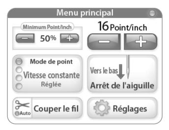
Juki Quilt Virtuoso Pro dispose d'un écran tactile 3,5" monté sur la poignée avant. L'écran LCD peut être enlevé et placé sur la poignée arrière optionnelle.
