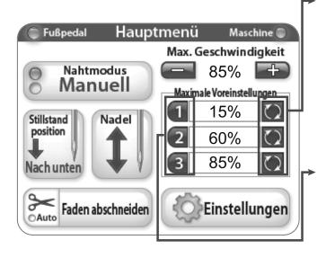
Maximale Voreinstellung – Aktualisierungstaste Diese Tasten speichern den aktuellen maximalen Geschwindigkeitswert als Voreinstellung.
