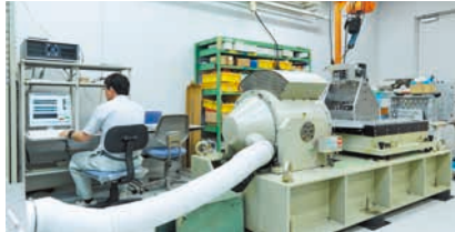
加振機を活用しての振動試験
