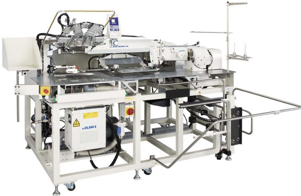
JUKIは、簡単な操作で脱技能化に貢献し、高い生産性と安定した縫い品質を実現した「ポケットセッター(ジーンズ仕様)AP-876」を海外は12月より、国内は来年の1月より発売します。ジーンズポケット付けの一連の工程である「ポケット生地折り、身頃へのセット、縫い付け、閉止め縫い」を完全自動化し、さらに、縫製された生地を自動的に積み重ねていくタック装置も標準で装備しています。
