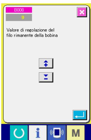
Schermo di impostazione del valore di regolazione della quantità rimanente di filo della bobina
