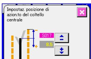
Schermo di impostazione della posizione di azionamento del coltello centrale (schermo A)
