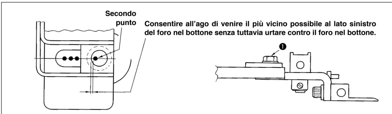
Quando si procede alla verifica della forma del modello di cucitura, adattare il secondo punto di entrata dell'ago al foro nel bottone e stringere vite ① . (Fare riferimento al par. relativo alla verifica della forma del modello di cucitura nel manuale d'istruzioni per la LK-1900A.)
