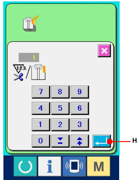
\* Wenn der Wert "0" eingegeben wird, erfolgt keine Zählung der Anzahl der Fadenabschneidevorgänge. Benutzen Sie diese Funktion durch Anschließen des externen Schalters.
