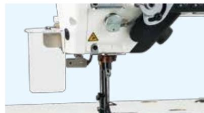
■ 縫製中の針折れの飛散を防ぎます。アイガードが開いているとマシンが動かない為、電源を切り忘れても針交換時など予期せぬマシン起動がおきません。
