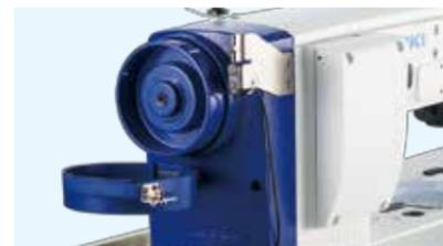
■ 電源が入っている状況で、はずみ車カバーが開いている場合は、マシンが起動しません。また、縫製中は、糸や生地などをはずみ車に巻き込むことを防ぎます。
