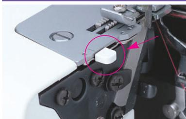
全巻きと細ロックの2種類の巻き縫いは、かがり幅切り替えつまみを操作するだけのワンタッチ操作です。
