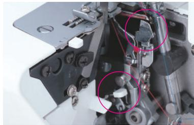
下ルーパーの糸通しが簡単になりました。レバーを押してフックに糸を掛け、レバーを操作するだけで糸掛けが簡単です。
