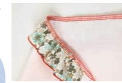
差動送りをN~2.0の間で調節し、ギャザーを寄せたい布を下にして2枚を重ねて縫うと下の布を自動的に寄せながら縫い進みます。目盛りを大きくするほどギャザーの量は多くなります。手で縫い縮めるよりも均等なギャザーに。
