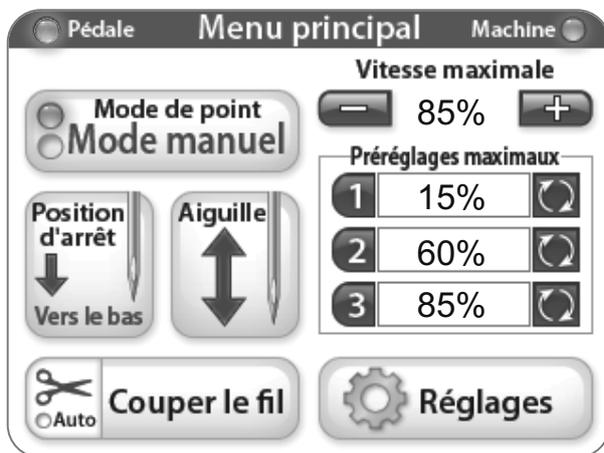
Juki Quilt Virtuoso Pro dispose d'un écran tactile 3,5" monté sur la tête de la machine.
