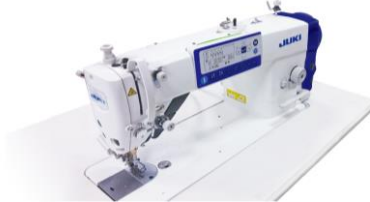
ダイレクトドライブ高速1本針 本縫自動糸切りミシン DDL-8000AS/DDDL-8000AB (2019年4月認定)
